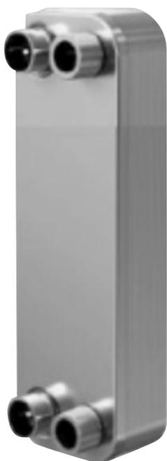
Gli scambiatori a piastre saldobrasati in acciaio inox eliminano la necessità di guarnizioni e riducono lo spessore dello scambiatore. La brasatura assicura la tenuta idraulica e mantiene le piastre connesse tra di loro, assicurando un'ottima efficienza di scambio termico ed una elevata resistenza alla pressione.
