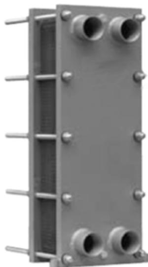
**Piastre:** Le piastre sono realizzate in acciaio INOX AISI 316L con spessore 0,5 mm. L'utilizzo di questi materiali e spessore consente di ottenere un ottimo coefficiente di scambio globale e garantisce un'ottima resistenza alla corrosione.
